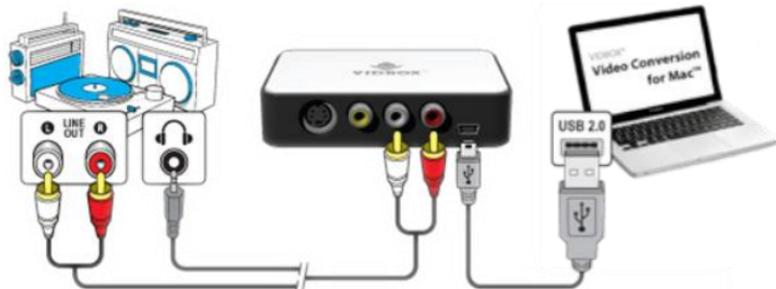
As conexões do reproduutor de áudio podem ser feitas através de **cabos RCA estéreo** ou com um **cabo adaptador de fone de ouvido para adaptador RCA estéreo (não incluso)**.
