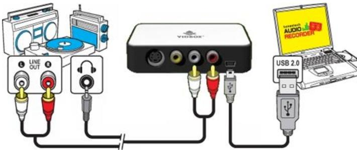
As conexões do reproduutor de áudio podem ser feitas através de **cabos RCA (Compostos)** ou com um **cablo adaptador de fone de ouvido para adaptador RCA (Composto)**.
