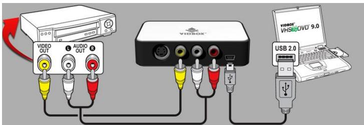
As conexões de seu reproduutor de vídeo podem ser feitas via **cabos RCA (Composto)** (acima) ou com uma combinação de **cabos de áudio S-Video e RCA (Composto)** (abaixo).
