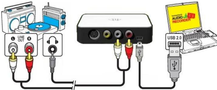
As conexões do reproduutor de áudio podem ser feitas através de **cabos RCA (Compostos)** ou com um **cablo adaptador de fone de ouvido para adaptador RCA (Composto)**.
