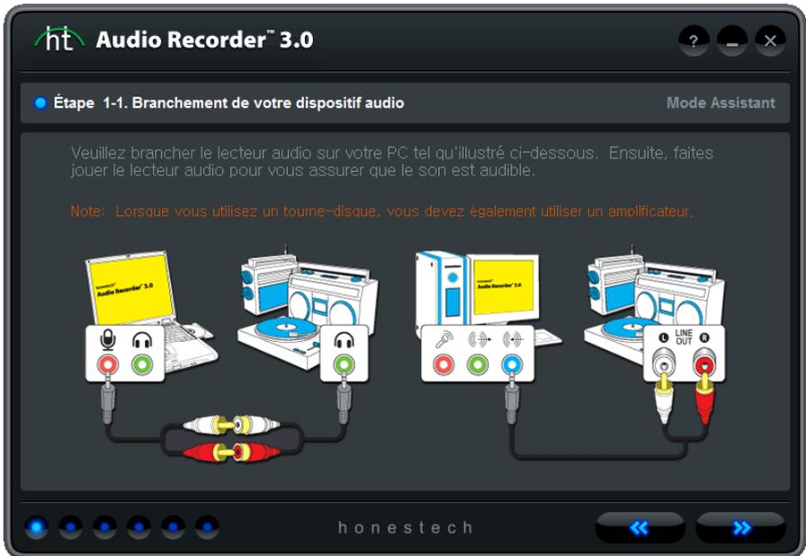
1. Si votre dispositif de lecture audio est pourvu de connecteurs RCA « line-Out », utilisez un câble audio avec des fiches RCA à une extrémité et une fiche de 3,5 mm à l'autre extrémité.
